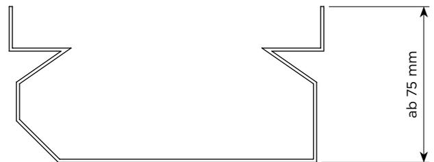
Ausführung des Rinnenkörpers bei Bauhöhen ab 75 mm
