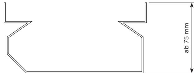
Ausführung des Rinnenkörpers bei Bauhöhen ab 75 mm
