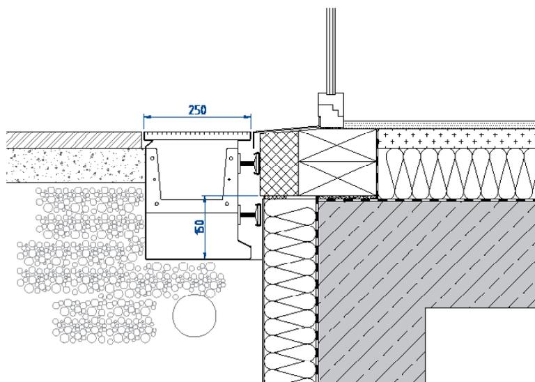
QUERSCHNITT SOCKELRINNE MIT AUSKRAGUNG
